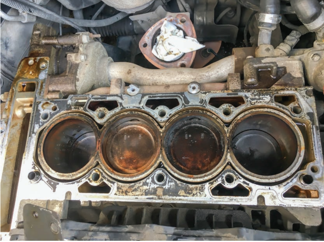
படம் (2) சிலிண்டர் பிளாக் – கரிப் படிவம் நீக்கு வதற்கு முன்
