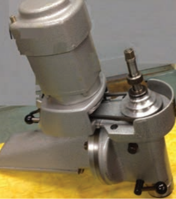
அதிவேக மில்லிங் சேர்க்கை (High Speed Milling Attachment)
