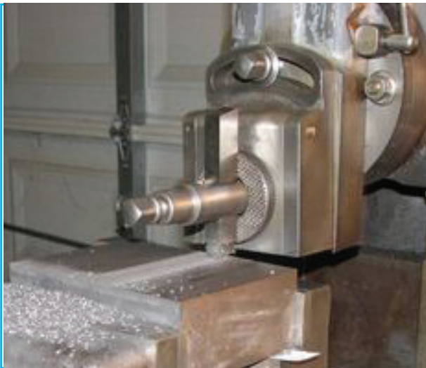
செங்குத்துப் பரப்பு இழைத்தல் (Machining vertical surfaces)
