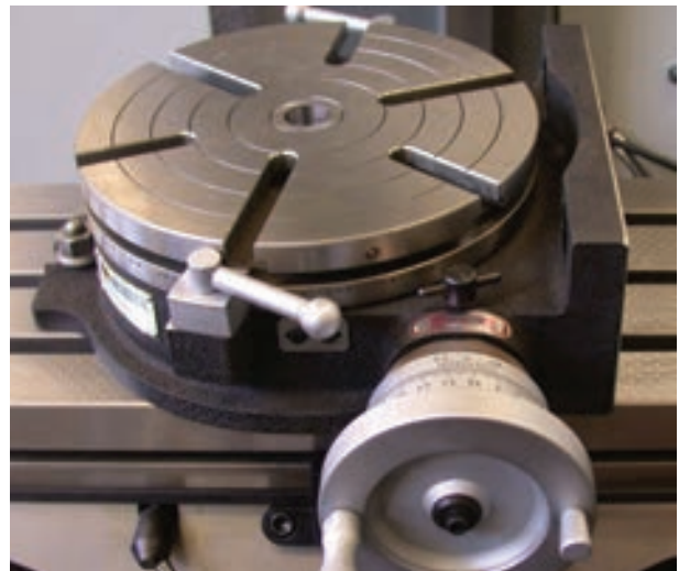
சுழலும் பணிமேடை சேர்க்கை (Rotary Table Milling Attachment)
