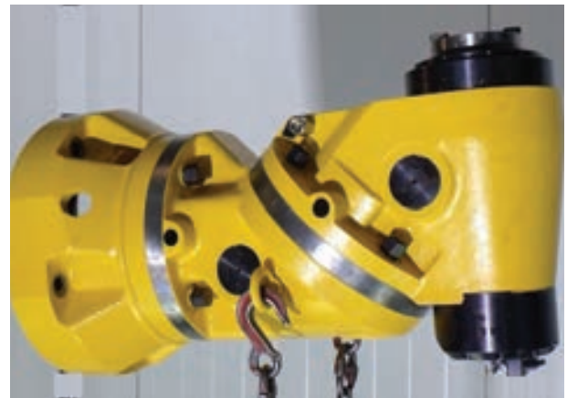
யுனிவர்சல் மில்லிங் தலை (Universal Milling Attachment)
