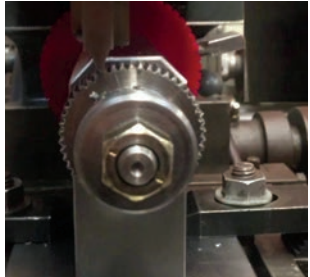
தட்டைப் பல்லிணை வெட்டுதல் (Machining Rackgear)
