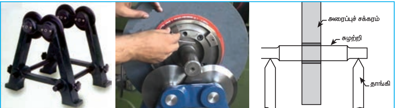
அரைப்புச் சக்கரத்தை பேலன்ஸ் செய்தல் (Wheel Balancing)
