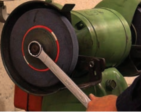
அரைப்புச் சக்கரத்தை பொருத்தும் முறை (Method of Mounting Grinding Wheel)
