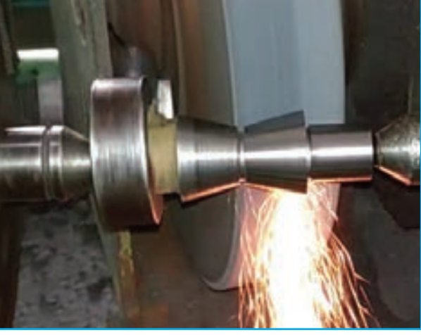
சரிவு உருளை அரைப்புச் செயல் (Form Grinding)
