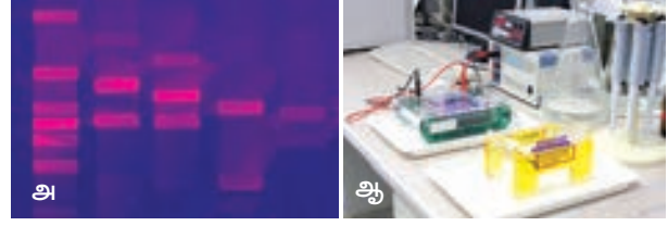
படம் 4.17: அ. அகரோஸ் இழுமத்தில் DNAவின் பட்டை ஆ. இழும மின்னாற்பிரிப்புக் கருவி
