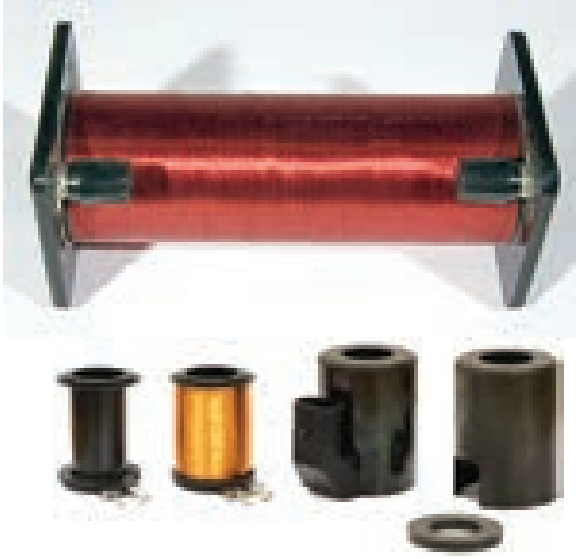
முனைகளுள்ள, கம்பிச்சுருள் சுற்றப்பட்ட சக்கரம் சுற்றப்பட்ட கம்பிச்சுருள் வெளிப்புறம் மூடப்பட்ட கம்பிச்சுருள் கம்பிச்சுருள் கிண்ணம் (காந்தப்பாய கூண்டு) மற்றும் காந்தப்பாய தட்டைச்சுருள்
